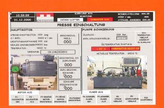
Die einfache und übersichtliche Bedienung der europress hilft dem Benutzer, die Prozessdaten jederzeit zu steuern und überwachen. Die Visualisierung hilft bei der schnellen und fehlerfreien Programmierung der Prozessdaten.
