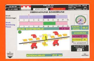
Die Überwachung und Darstellung von Maschinendaten, wie beispielsweise die Temperaturen an den Lagerstellen der Hauptwelle, helfen bei der schnellen Fehlererkennung und reduzieren die Stillstandzeiten.
